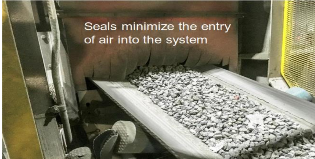
Figura 7. Sello transversal existente que va sobre el material
