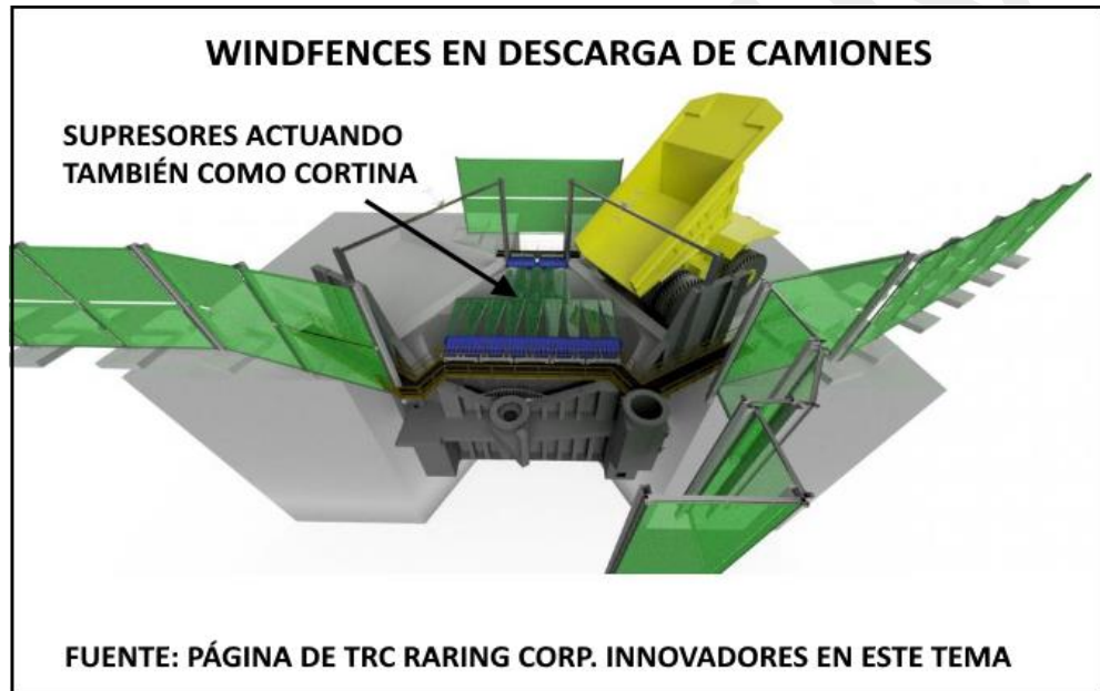
Figura 11. Esquema con ubicación de windfences de TRC Raring
